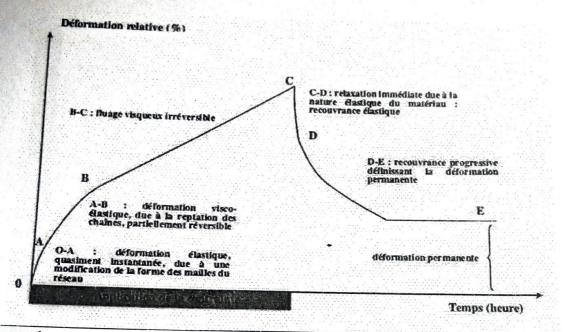
graphe temps/déformation, caractéristique d'un matériau visco-élastique soumis à une charge statique (partie OC), puis libéré de cette charge (partie CE)
